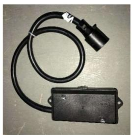
BE SURE TO PLUG THE 7 PIN CONNECTOR WITH THE PROPER HOLES AT TOP AND BOTTOM. FAILURE TO DO SO MAY DAMAGE YOUR TRAILER WIRING AND ELECTRIC BRAKE SYSTEM.
